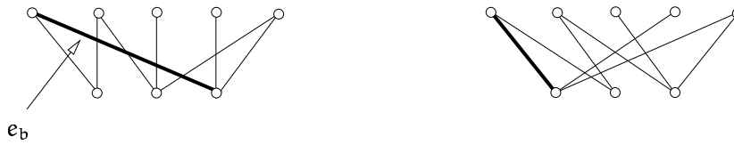
Abbildung 7.12: Gewichtete Kreuzungszahl. Eine breite Kante e_b soll sich möglichst wenig mit anderen Kanten kreuzen. (links) Bei fester Anordnung der Knoten in L_1 ist hier die Gesamtzahl der Kreuzungen minimal, jedoch kreuzt e_b vier andere Kanten. Erhalten die Kanten Kreuzungsgewichte mit KG(e_b) = 3 und KG(e) = 1 für alle anderen Kanten e , so beträgt die gewichtete Kreuzungszahl 18. (rechts) Nun ist eine Anordnung mit kleinerer gewichteter Kreuzungszahl möglich, auch wenn die Gesamtzahl der Kreuzungen größer ist.
